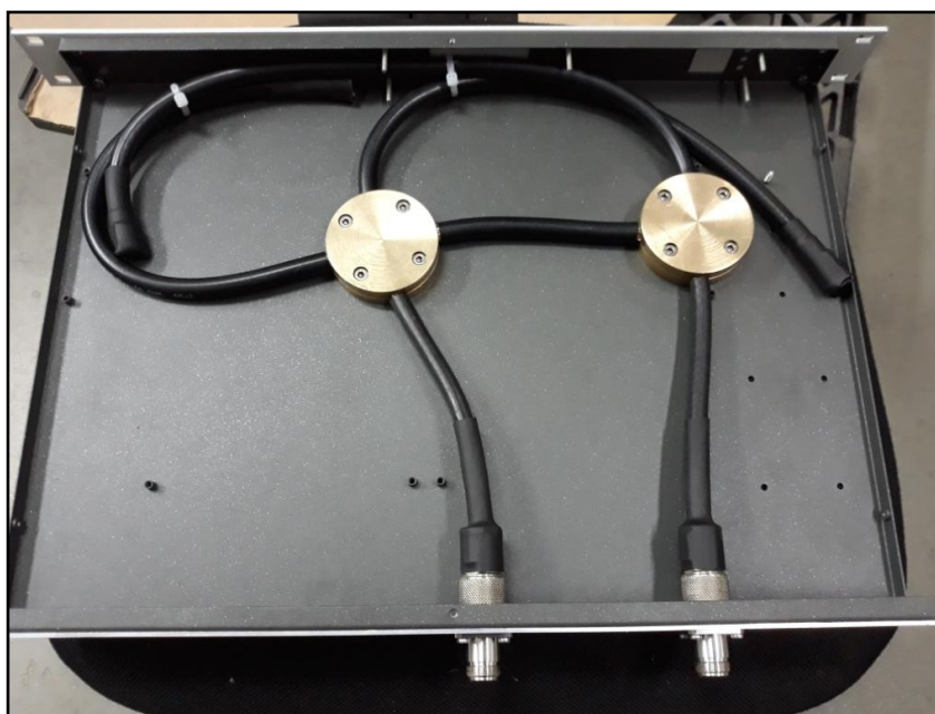
5. Filtro triple notch en frecuencias interferentes en la banda aeronáutica capaz de 300 W. Ubicación entre excitador y amplificador
