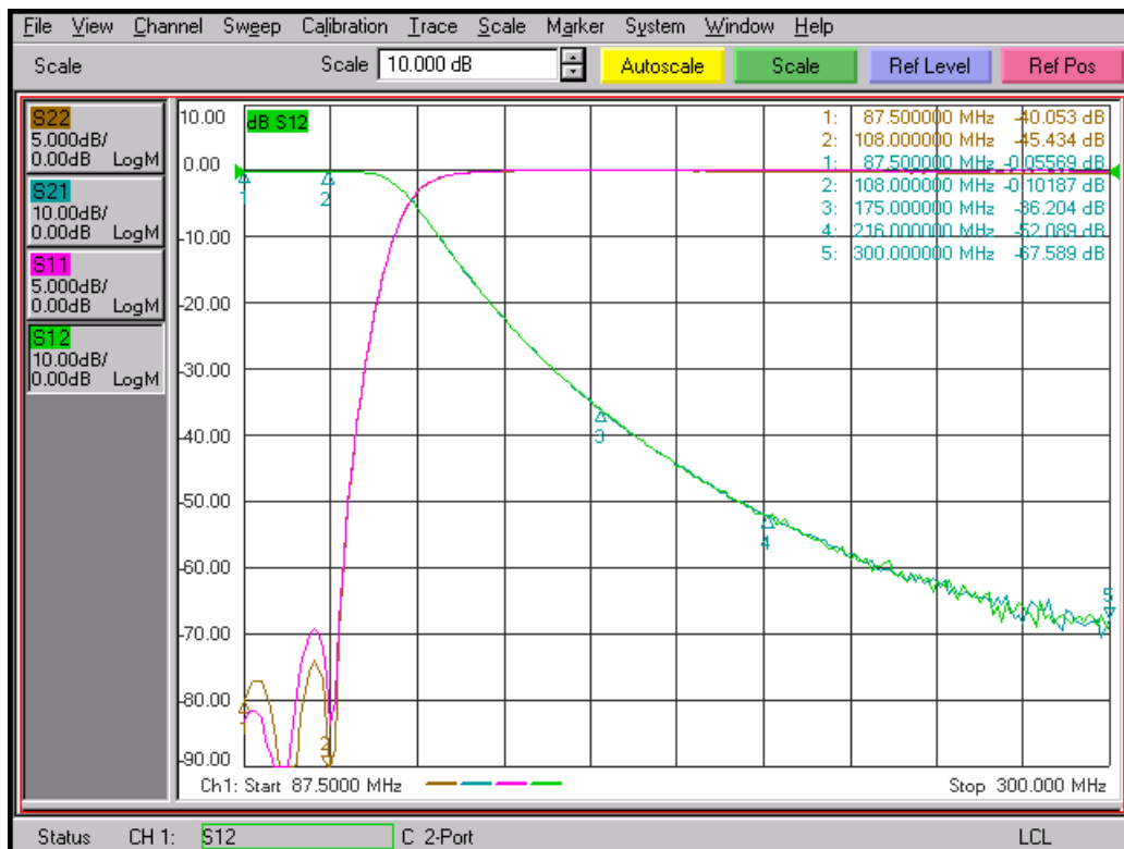
2. Respuesta completa de un filtro paso-bajo empleado para eliminar interferencias en TETRA
