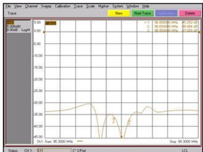
PÉRDIDAS DE RETORNO BE / RETURN LOSS NB
