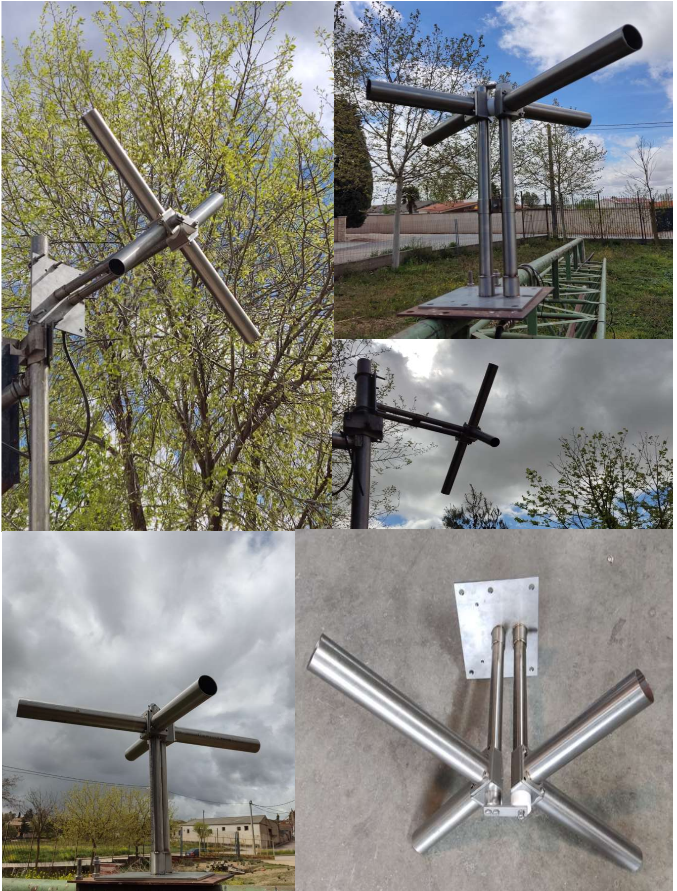
Figura 8: Pruebas, medidas en campo y fabricación del primer prototipo de Antena QADAB
